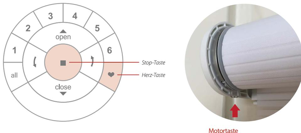
Dafür müssen Sie den **Programmiermodus** aktivieren, um die Kommunikation zwischen der Fernbedienung und dem Motor der Sonnenschutzanlage herzustellen.
