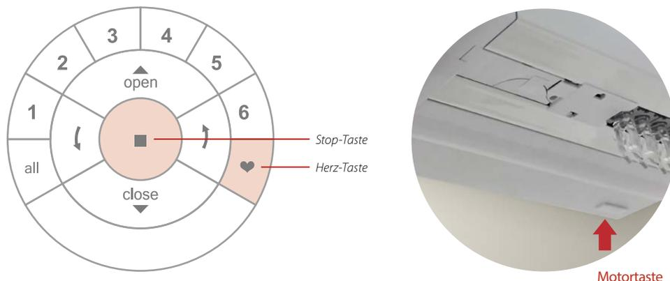
Dafür müssen Sie den **Programmiermodus** aktivieren, um die Kommunikation zwischen der Fernbedienung und dem Motor der Sonnenschutzanlage herzustellen.
