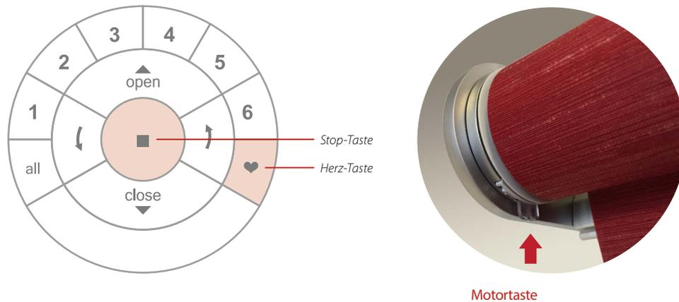
Dafür müssen Sie den **Programmiermodus** auf der PowerView® Fernbedienung aktivieren, um die Kommunikation zwischen der Fernbedienung und dem Motor der Sonnenschutzanlage herzustellen.
