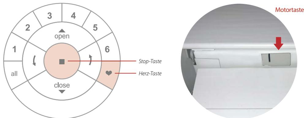
Dafür müssen Sie den **Programmiermodus** auf der PowerView® Fernbedienung aktivieren, um die Kommunikation zwischen der Fernbedienung und dem Motor der Sonnenschutzanlage herzustellen.
